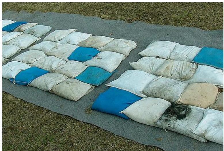
Foto 25: Auflast am Übungsdeich in Seehausen
