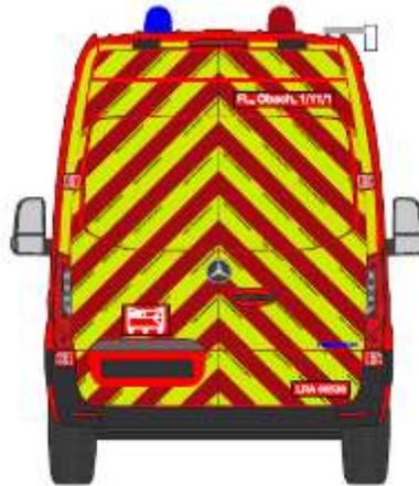
Bei Lösch- und Sonderfahrzeugen, wie LF, TLF, RW, AB, GW, GKW, ..., kann auch die Beschriftung mit Telefonsymbol und 112 zusätzlich an geeigneter Stelle erfolgen. z.B. in nachfolgendem Design:
